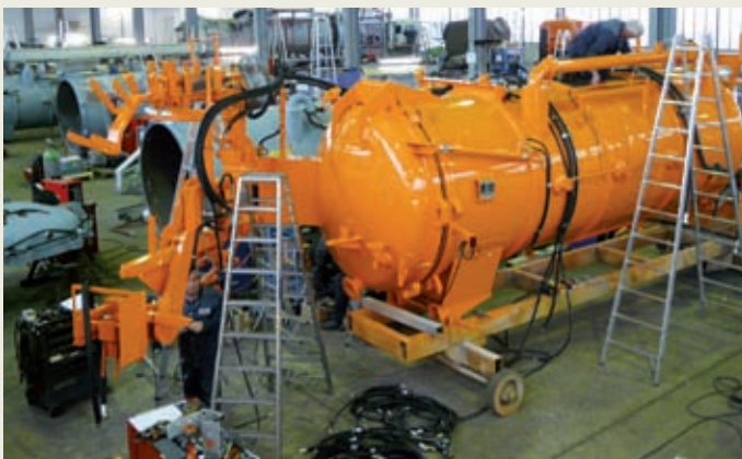
▲ Große Lkw-Aufbauten werden in der Lackiererei von Kroll komplett lackiert. Später werden noch zahlreiche Einzelteile montiert, die man separat beschichtet.
